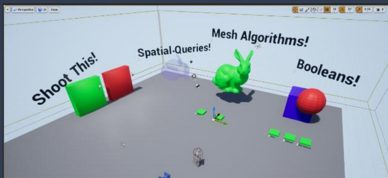
◆ 在第一个演示区域中，有两个动态网格Actor（本例中为SMC，但并不必须是SMC）。红色球体正在做着transformation的动画，当你踩到地面上标有“求合集、求差集”和“求交集”的三个按钮之一时，布尔操作将应用于这两个对象，并且球体将被删除。负责控制的Actor BP\_ApplyBooleanButton，代码如下所示。基本上，当你踩到不同的绿色框，它将改变材质，然后我们得到目标和另一个Actor，并调用ADynamicMeshBaseActor::BooleanwithMesh（目标，另一个）。然后第二个Actor将会被销毁。就辣么简单！
