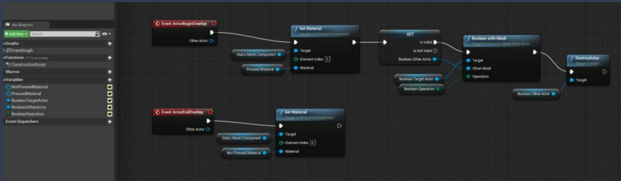
◆ 每个演示的对象被分组到一个文件夹中，如下图所示。下面另一张是上述Button\_XYZ Actor蓝图的“详细信息视图”属性。在这里，可以为每个Button蓝图实例配置各种参数。基本上，你将“目标”和“其他”参与者设置为当前关卡的两个网格参与者，然后选择一个布尔运算操作。此外，你还可以设置按钮“按下”和“抬起”的材质。SM\_ButtonBox静态网格在蓝图配置里仅注册了与Pawn重叠的事件，因此上图的ActorBeginOverlap仅在玩家角色与按钮重合时触发，然后调用布尔运算。
